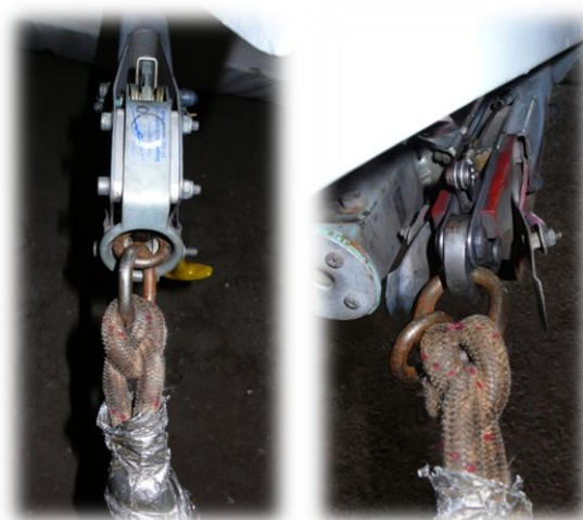
Accrochage du câble au remorqueur : le petit anneau sur HC, le gros pour IK.
